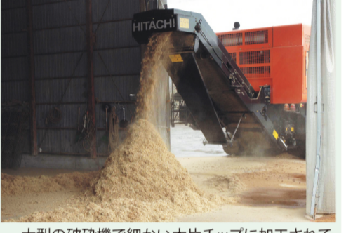
大型の破砕機で細かい木片チップに加工されている様子です。このチップは一番小さいもので、家畜の敷きわらに使用します。
