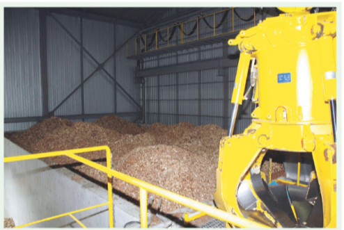
バイオマス発電所内の木片チップ集積所の様子。これらチップを燃料とし、奥にあるガス化炉でガス化反応が行われます。
